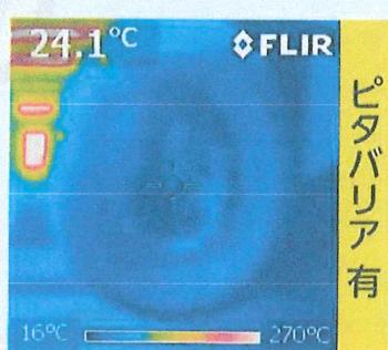
ヒーター800W 350mm 10分後 ヘルメット内温度測定結果（自社テストによる）
